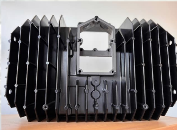
Støbt, cnc-bearbejdet og lakeret lampedel
