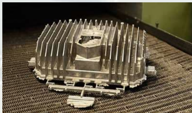
Rå støbt lampedel med køleribber
